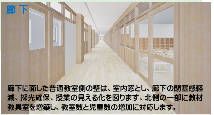
廊下 廊下に面した普通教室側の壁は、室内窓とし、廊下の閉塞感軽減、採光確保、授業の見える化を図ります。北側の一部に教材教具室を増築し、教室数と児童数の増加に対応します。
