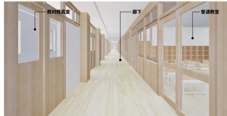
廊下に面した普通教室側の壁は、室内窓とし、廊下の閉塞感軽減、採光確保、授業の見える化を図ります。 北側の一部に教材教具室を増築し、教室数と児童数の増加に対応します。 1階廊下
