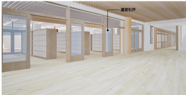
校舎の顔として、木の温もりを感じる内装デザインを提案します。 連窓引き戸で風除室の設えとすることで、直接の外気流入を緩和し空調負荷を低減します。 昇降口
